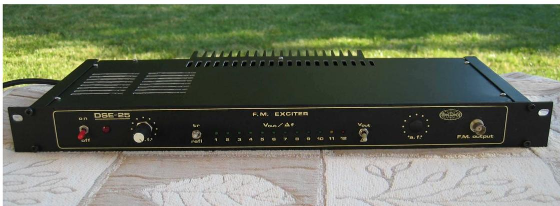
Le pilote synthétisé DSE-25 est le point de départ de l'émission. Il génère la fréquence de l'émetteur et effectue la modulation. C'est un appareil très complet, permettant l'émission en mono et en stéréo, avec ou sans RDS.
